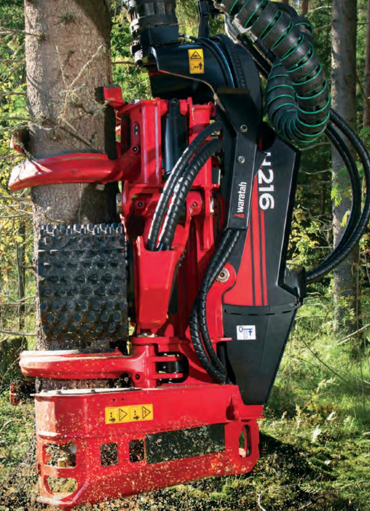
La tête d'abatteuse-façonneuse agile H216 facilite le travail du bois dur courbé. Sa conception simple avec une excellente puissance d'alimentation, d'ébranchage, de mesure précise et une grande capacité de coupe maximisent la productivité.
