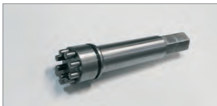
F062897 Hawe RK2 G3/8 Utilizado para verificar a válvula F008653. Válvulas principais: Classic, EVOII, EVOIII, Pevo
