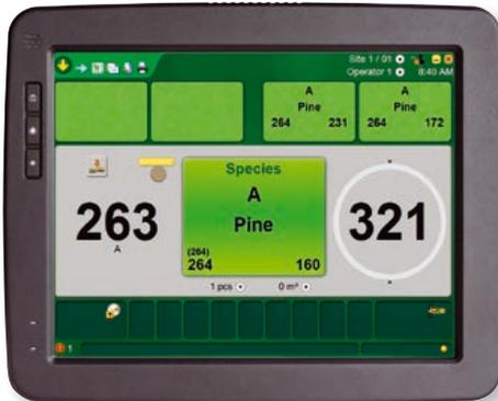
TimberRite H-16 eleva el control y, al mismo tiempo, le proporciona conectividad para mantenerle informado. Mediante la comunicación de la portadora del bus CAN, este sistema de fácil uso proporciona un control configurable y preciso del cabezal para aumentar la eficiencia y la productividad.
